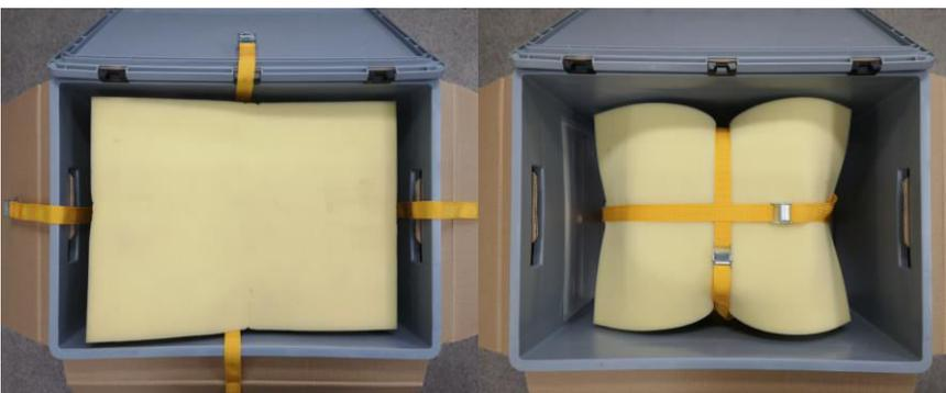
Schaumstoff auf dem Gerät platzieren & die Gurte über Kreuz fest ziehen, bis die Maschine fixiert ist
